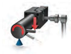
In questo esempio, è riportato il confronto tra HSK-A 63 e Coromant Capto C6 in termini di rigidità alla flessione ed alla torsione, eseguito dalla rinomata università RWTH di Aquisgrana, in Germania. I risultati evidenziano come il C6 abbia una resistenza al distacco delle superfici di contatto (dal momento in cui inizia a flettersi) 2.88 superiore a quella dell'HSK 63, e una resistenza alla torsione 2.3 volte superiore.
