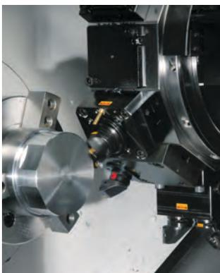
L'uso di adattatori di fresatura sui portautensili rotanti è consigliabile anche per mantenere gli utensili più corti possibile. Tuttavia, questa scelta è dovuta principalmente a ragioni di stabilità piuttosto che a restrizioni di spazio. I cuscinetti sono molto più ravvicinati sui portautensili rotanti che sui centri di lavoro. Grazie alla sporgenza ridotta, è possibile ridurre le vibrazioni, potendo quindi lavorare con maggiore produttività e sicurezza.
